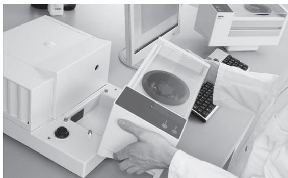
Installazione di una cella di misurazione
