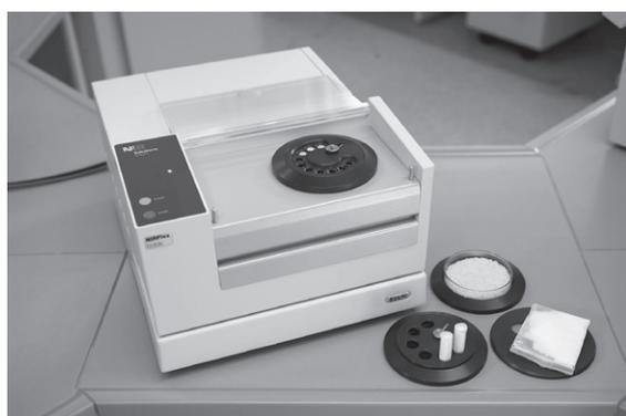
NIRFlex Solids è la configurazione ideale per misurare campioni solidi quali polveri, paste e pellet con la riflettanza diffusa. La cella di misurazione per solidi consente di utilizzare diversi accessori per recipienti specifici per campioni.
