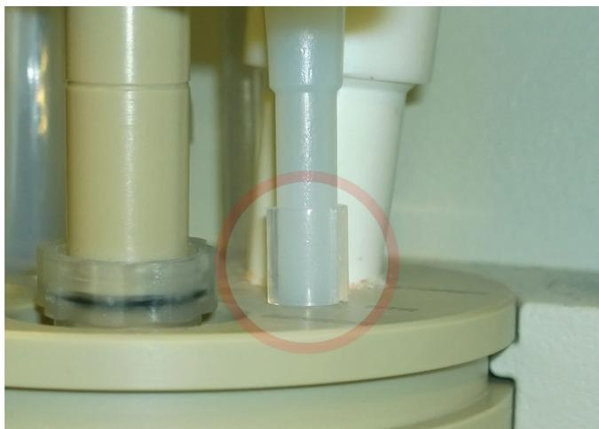
Fig. 5.12: Montage de l'élément d'espacement sur la pointe de dosage
