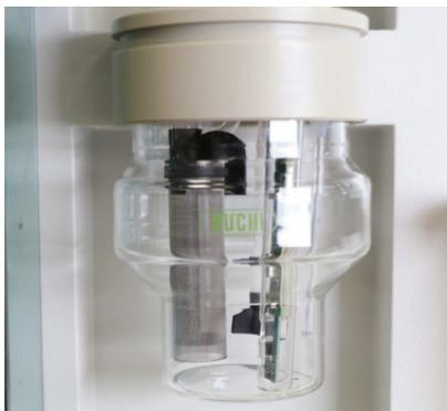
Fig. 5.17: Montage de la grille de protection sur la sonde
