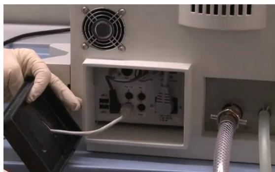
Fig. 5.11: Raccordement du câble du moteur d'entraînement
