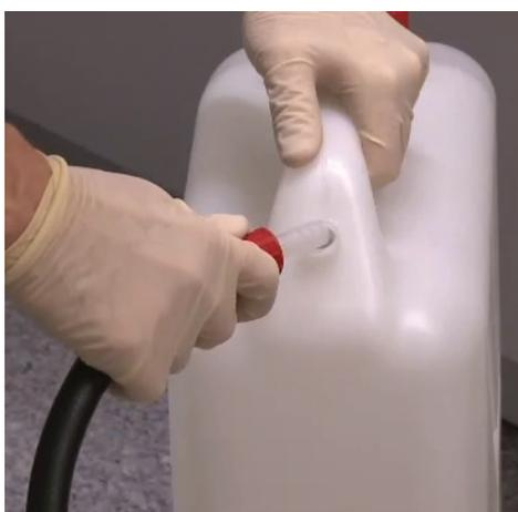
Fig. 5.7: Raccordement du tuyau de vidange à l'aide d'un raccord droit
