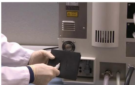
Fig. 5.10: Guidage du câble à travers la découpe
