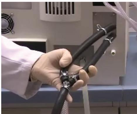
Fig. 5.6: Guidage de deux sorties dans un tuyau
