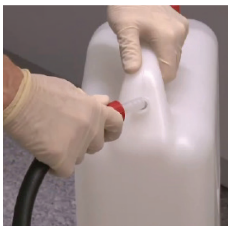
图 5.7: 使用直型接头连接排水软管
