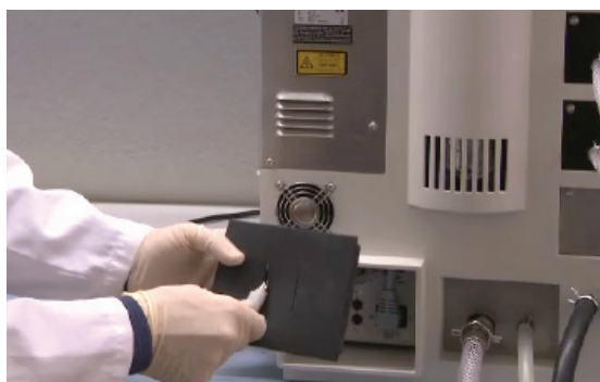
图 5.10: 通过开口引导电缆
