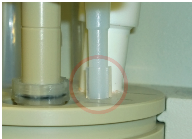
图 5.12: 将垫片安装到配液嘴上
