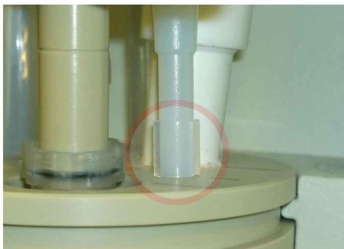
図5.12: ビュレットチップへのスペーサーの取り付け
