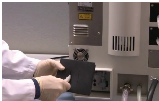
図5.10: 開口部からのケーブルの引き出し
