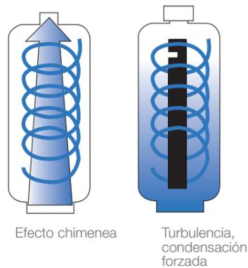
Al evaporarse (cambio del estado líquido al gaseoso), el volumen de la muestra se multiplica por hasta 20 000. En el condensador, el gas se recondensa, vuelve a un estado líquido y el volumen se reduce de inmediato. Durante este proceso de evaporación-condensación, la velocidad del vapor en los puntos más estrechos de la unidad de vidrio puede alcanzar hasta 150 km/h.
