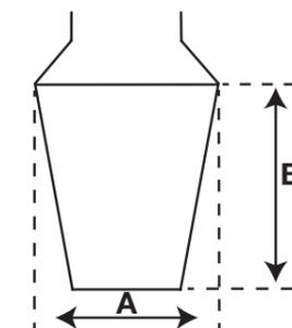
El par de números (por ejemplo, 29/32) describe un tamaño de unión. El primer número hace referencia a la anchura de la unión (A). El segundo número (después de la barra) hace referencia a la longitud de la unión (B). Por lo tanto, 29/32 indica que la unión tiene una anchura de 29 mm y una longitud de 32 mm.
