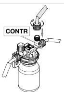
▶ Den Schlauch an die Kontrolleinheit I-80 / I-180 anschliessen.
