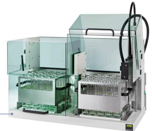
「BUCHI製自動ケルダールシステムは、48ポジションのオートサンプラーで連続測定が可能のため、作業時間を大幅に節約することができます」
