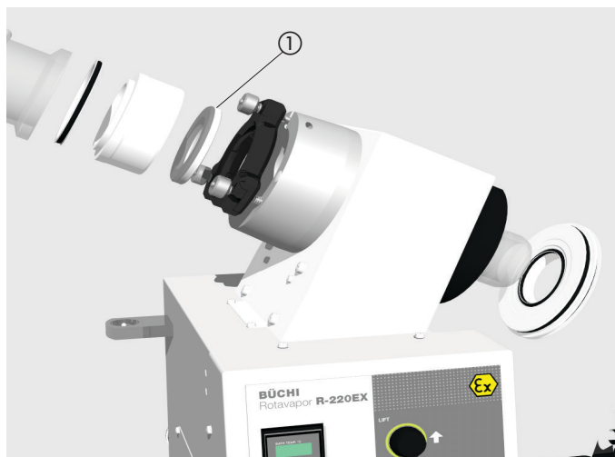
Bild 6.6: Auswechseln der Dichtungen zum Verteilstück
