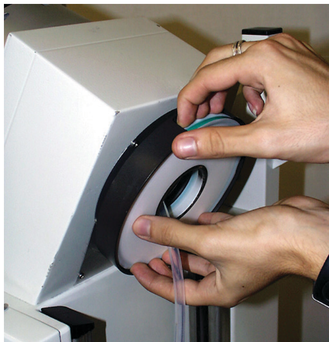
Figura 6.3: Rimuovere la guarnizione del pallone evaporatore
