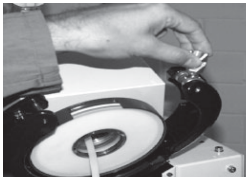
Figura 4.14: Regolazione della tensione di chiusura
