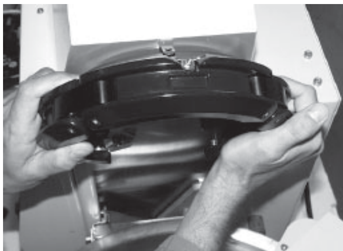
Figura 6.2: Montaggio del collegamento del collo del pallone
