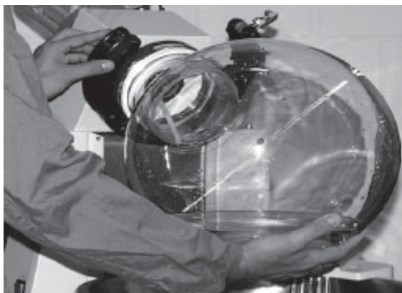
Figura 4.12: Collegamento del collo del pallone con pallone introdotto
