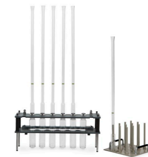
Chemical Oxygen Demand (menggunakan air reflux condenser)
