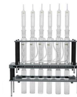
Trace metal dan hidroxiprolin (menggunakan water reflux condenser)
