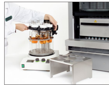
Évaporation des solvants sur Multivapor™
