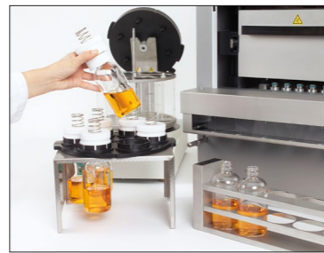
Transfert d'échantillons de SpeedExtractor à Multivapor™
