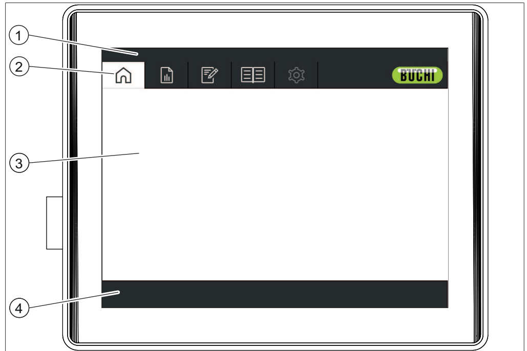
Fig. 5: Panneau de contrôle
