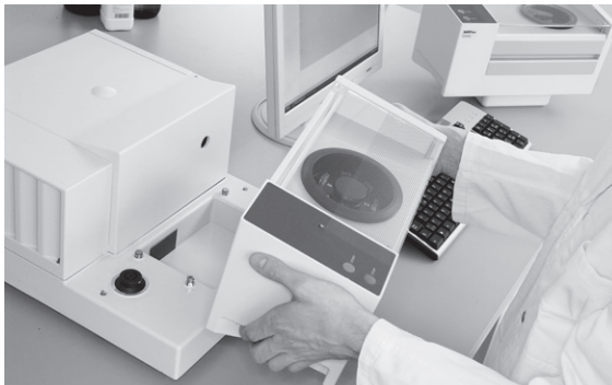
Instalación de una célula de medición
