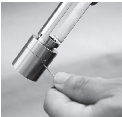
Sustitución del anillo espaciador
