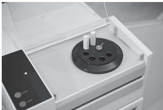
NIRFlex Solids con accesorio para viales
