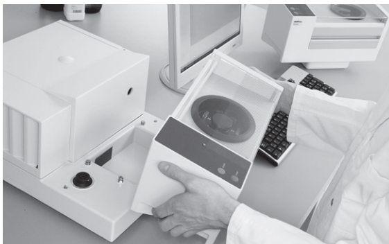
Installation einer Messzelle
