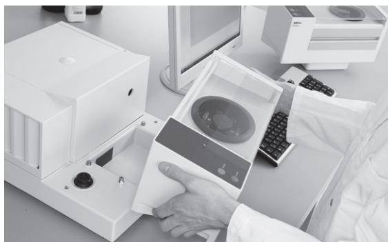
Installation d'une cellule de mesure
