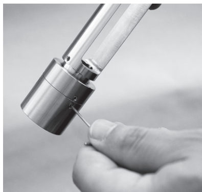
Remplacement de la bague entretoise
