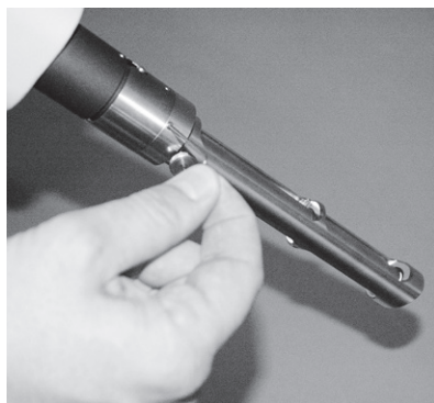
Ajustement de la distance de transmission
